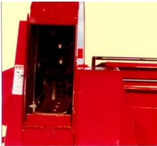
Schalenförmige Wurf-schaufeln sind durch eine seitliche Hinter-scheibe miteinander verbunden. Das Fördergut wird von der Zuführschnecke ohne einen Impulsverlust ins Fütter-silo geführt.
