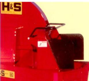
Mit einer einfachen Abschaltkupplung für die Zuführschnecke. Der einfache Einfülltrog ist mit Gummischürzen versehen.
