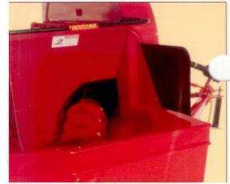
Die Zuführschnecke mit einem Durchmesser von 30cm ist in einem Winkel von 30° zum Wurfrad angebracht.
