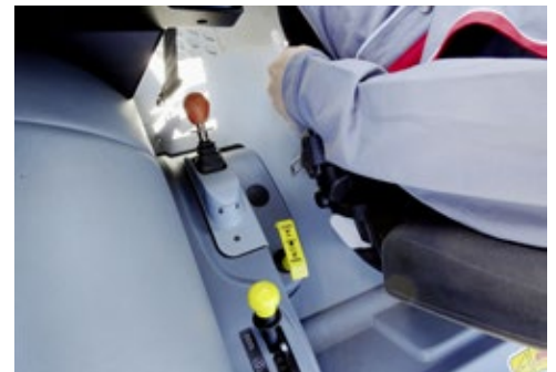
Optional verfügbar: mechanisch-hydraulisch kombinierte Parkbremse für absolute Sicherheit bei jedem Gefälle.
