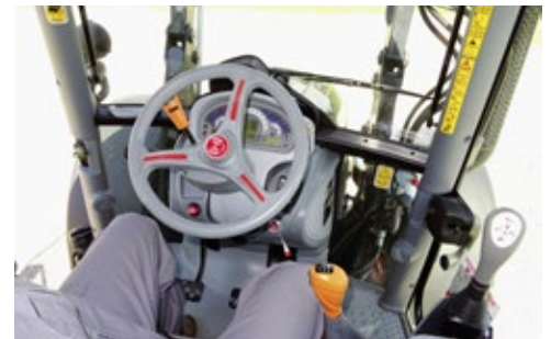
Die 4-Pfosten-Bauweise bietet gute Rundumsicht und einen hellen Arbeitsplatz.
