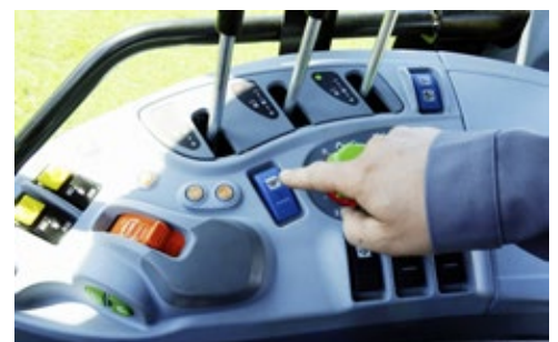
Per Kippschalter kann die «Eco»-Pumpe zugeschaltet werden, sodass die maximale Ölfördermenge bereits bei 1600 U/min erreicht wird.
